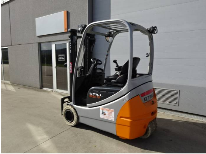
(2231) Heftruck Still RX20-18 elektrisch 1.8 ton hefvermogen
